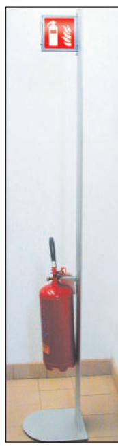
Questa colonna porta estintore è costituita da un doppio tubolare ovale in alluminio anodizzato argento, fissato su una base in ferro formato 350x280 mm spessore 10 mm, ricoperta da un foglio in alluminio anodizzato.
